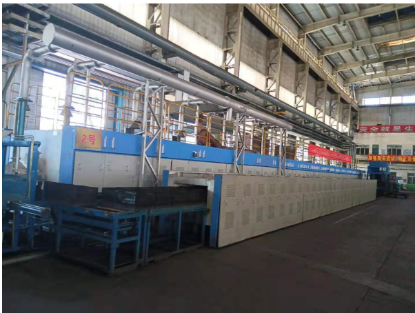
图 5-3 2#新型推板窑
