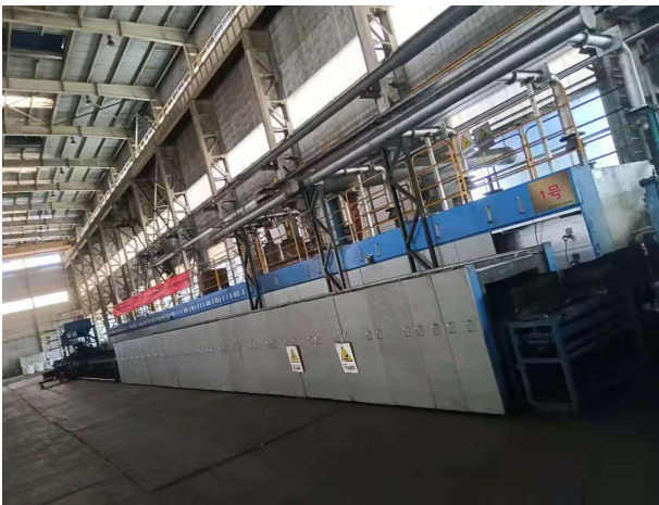
图 5-2 1#新型推板窑
