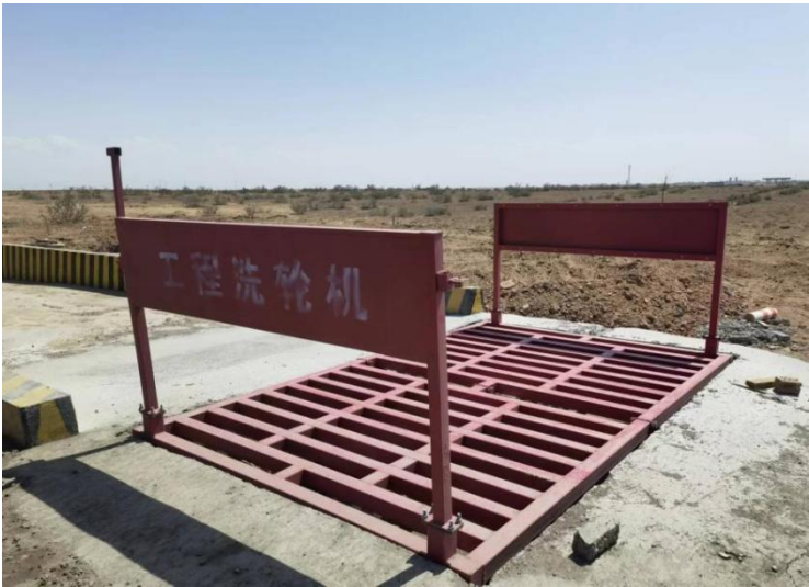
图 4-2 车辆轮胎清洗设施
