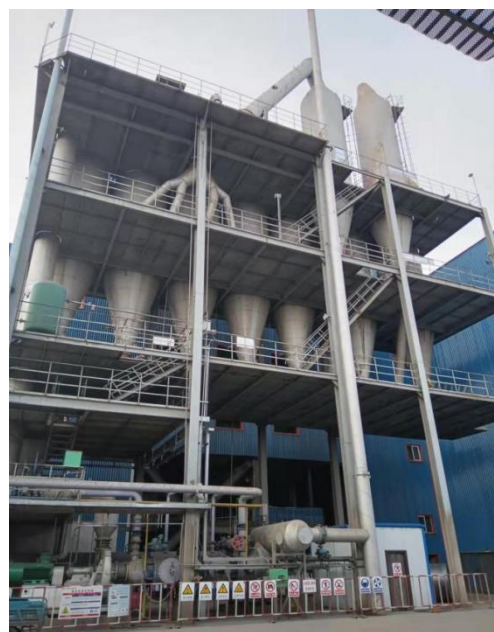
图 5-4 12#矿热炉净化系统
