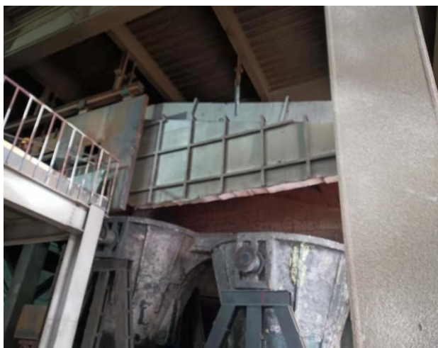
图 5-5 出铁口集气罩
