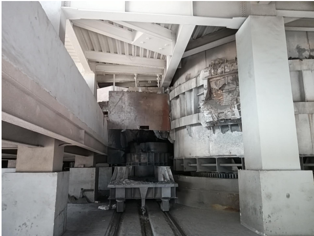
图 4-8 浇铸车间上方集气罩
