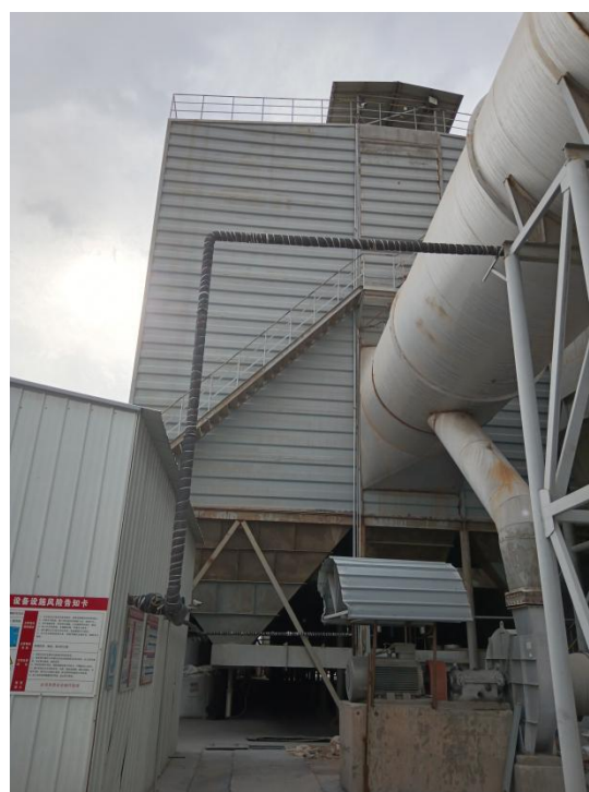
图 4-4 1#矿热炉布袋除尘器
