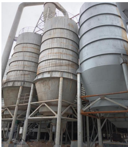
图 4-5 1#矿热炉微硅加密装置
